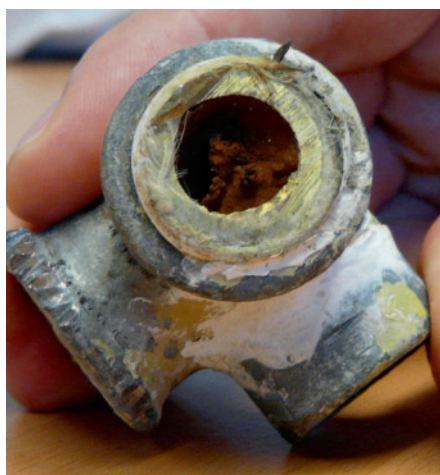
Detail van een opgedroogde biofilm in een waterleiding.
